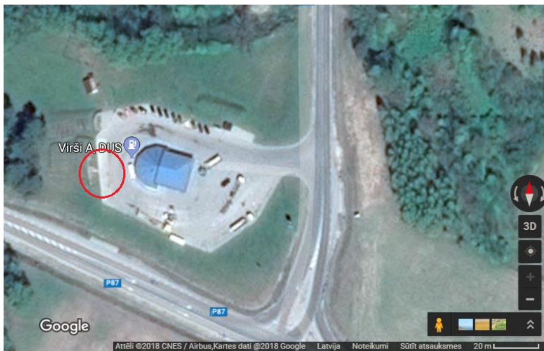
37. attēls. Maksimālā 1 % letālās iedarbības izplatība pie noplūdes no autocisternas Scenārijs Nr.4. Gāzes noplūde tehnoloģisko iekārtu savienojumu defektu rezultātā un momentāna gāzes aizdegšanās.
