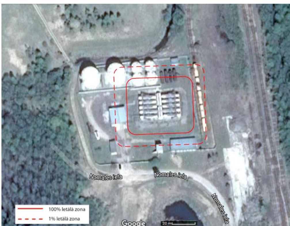
35.attēls Siltumstarojuma zonas tvertnes sabrukuma un aizdegšanās gadījumā 100m 3 tvertņu laukumā
